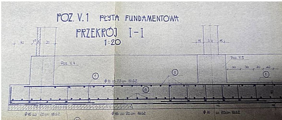
Rys. 4.1.3 Zbrojenie płyty fundamentowej, pasmo skrajne, fragment .
